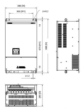
(6) N700E-1100HF/1320HFP, N700E-1320HF/1600HFPmodel external dimension.(mm)
