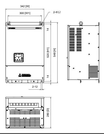
(5) N700E-750HF/900HFP, N700E-900HF/1100HFPmodel external dimension.(mm)
